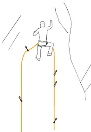
Les cordes à double sont plus fines, plus légères et plus élastiques que les cordes à simple. Elles sont conçues pour être utilisées en brin double. Dans l'escalade en tête, on utilise deux brins qui ne doivent pas être passés dans le même mousqueton. La norme prévoit que le grimpeur suivant peut être assuré à un seul brin. Les cordes à double sont proposées dans des diamètres entre 7,8 et 9,1 mm.
