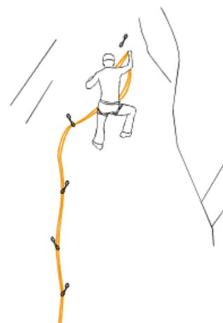
Les cordes jumelées sont encore plus fines, plus légères et plus élastiques. Elles doivent aussi être utilisées en double brin. Ceux-ci doivent toujours être menés en parallèle. Le grimpeur suivant doit aussi être assuré à deux brins. Les cordes jumelées sont proposées dans des diamètres entre 7,5 et 9,1 mm. La norme européenne ne donne cependant aucune indication explicite quant à l'utilisation des cordes sur glacier.
