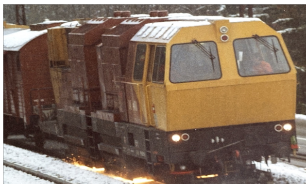
Train de meulage sur la ligne Lausanne-Vallorbe
